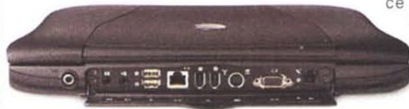
Il retro del nuovo Powerbook, con le porte Firewire al posto della SCSI.
